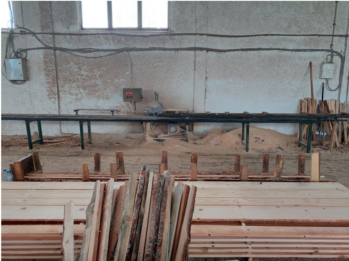
Слика 15. Кружна пила за надолжно режење
