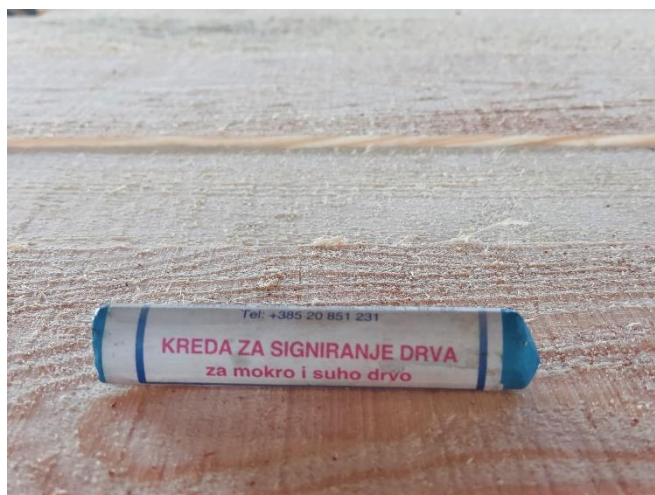
Слика 22. Шумска креда (ила) за обележување на неокрајчените сортименти
